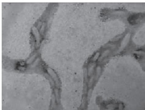
Imagen 4. Detalle de galerías realizadas por termita subterránea. (Morales, M. 2011)
