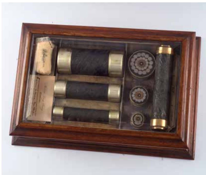
Figura 8. Caja de madera y cristal que contiene distintos tipos de cables compuestos de cobre, alambre y látex solidificado. Surdoc 3-2695. © Museo Histórico Nacional.
