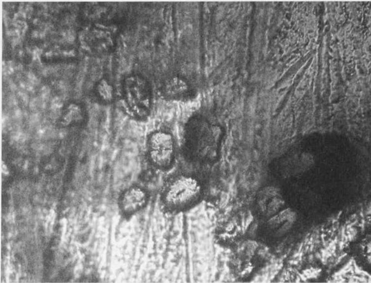
20. Corte transversal de las fibras de lino del soporte. Microscopia óptica,
