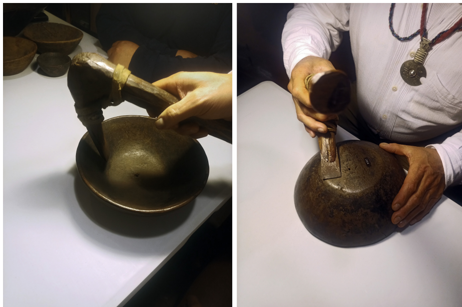
Figura 8. El mamülfé Héctor Curiqueo Melivilu muestra dos modos distintos de utilizar el maichihue , un tipo de azuela artesanal de hoja metálica plana: a la izquierda, como herramienta de desbaste para el vaciado interior del rali , mediante aplicación por golpe directo; y, a la derecha, como herramienta de cepillado para terminación exterior, aplicada por presión.
