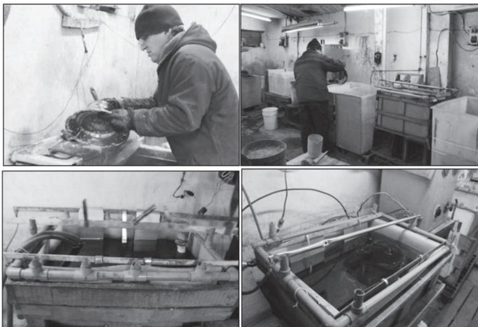
Figura 7. Sección de galvanoplastia. Izquierda arriba: Detalle. Derecha arriba: Vista general de la sección. Izquierda abajo: Piscina de plata. Derecha abajo: Piscina de níquel. (Fotografías Paloma Molina)
