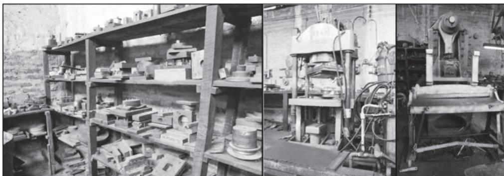
Figura 2. Sección de matricería. Izquierda: Moldes Centro: Estampadora Derecha: Cortadora.
