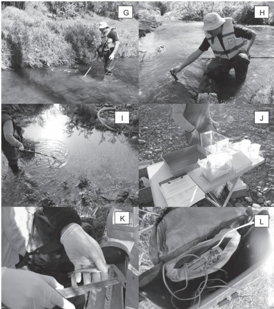
(G) pesca eléctrica (H) medición de parámetros (I) trabajo en pozones (J) laboratorio de campo (K) mediciones biométricas de individuos y (L) equipo de pesca.
